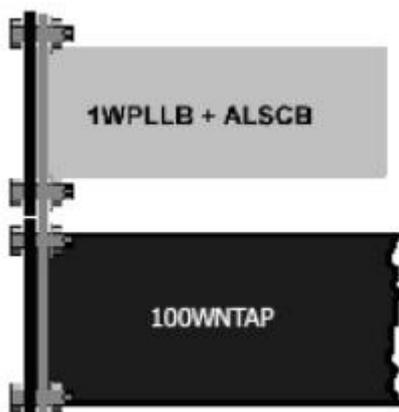
Organizar las unidades como se muestra el diagrama a su izquierda: Utilice los tornillos M6, tuercas, arandelas y barras de perforación para sujetar el controlador, el amplificador de potencia y los amplificadores de, estos son mucho más pesados, por lo que deben estar en la parte baja. El conductor y el amplificador de distribución son ligeros y se suspenden en el aire y no necesitan ningún tipo de apoyo en la parte posterior.
